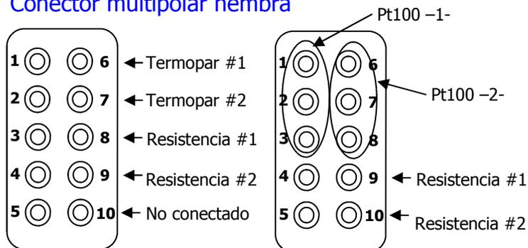
En el extremo del cable de salida se instala un conector multipolar. La conexión estándar es:
